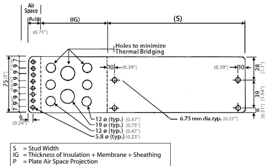
Figure 1 Stud Shear™ Connector Flat Plate
